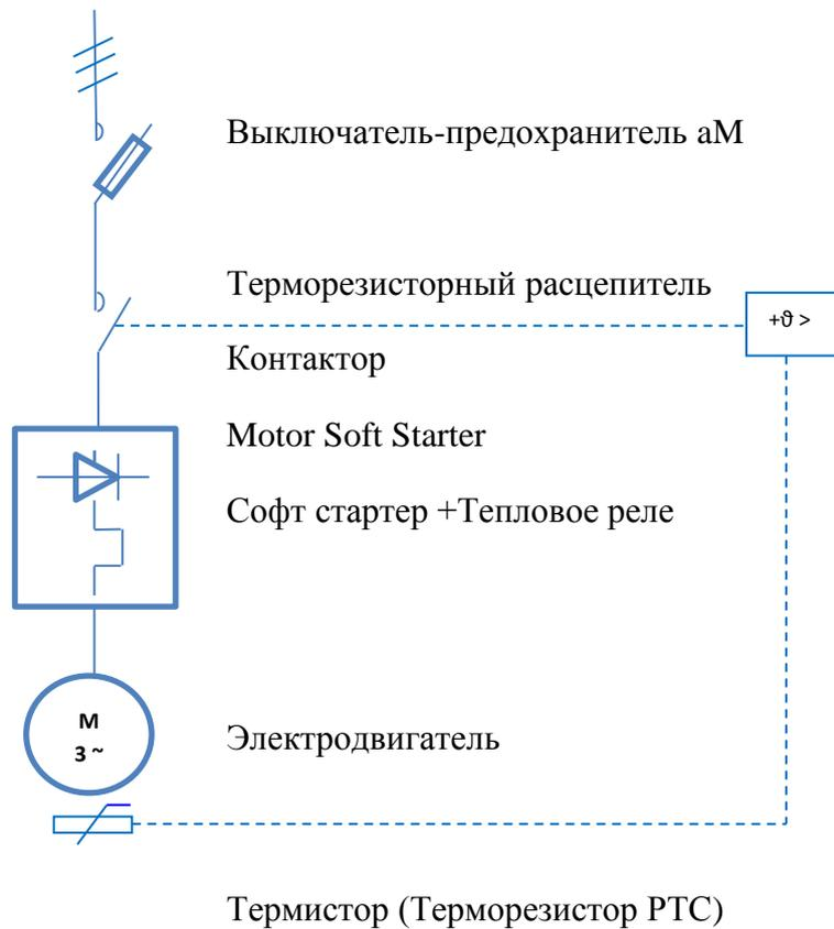
**Рис.6.** Комбинация «выключатель предохранитель aM – контактор – софт стартер с тепловым реле – термисторная защита»:
